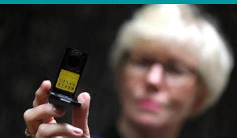
Ce boîtier est un dosimètre utilisé pour mesurer le radon dans une habitation. © Maxppp-Lionel Vadam.
